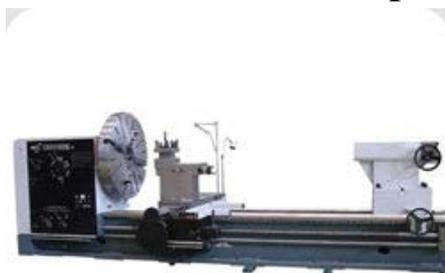
Тяжелые токарные станки CW61160M предназначены для черновой, получистовой и чистовой обработки заготовок из металлов и др. материалов в виде тел вращения. На станке можно производить точение внешних и внутренних цилиндрических и конических поверхностей, подрезку торца, сверление, снятие фаски, зенкерование, зенкование и развертывание, нарезание метрической, модульной, дюймовой и питчевой резьбы.
