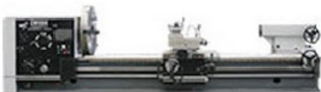
Тяжелый токарный станок CW61140M предназначен для черновой, получистовой и чистовой обработки заготовок из металлов и других материалов в виде тел вращения. Полностью использовать возможности современных твердосплавных и обычных
