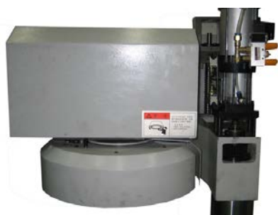
Магазин смены инструмента и шпиндель 10 000 об/мин
