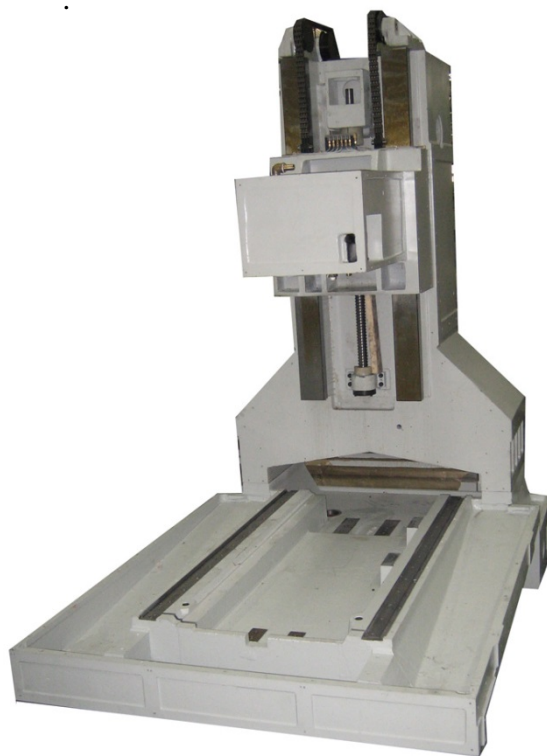
Станина вертикального обрабатывающего центра. Салазки оси Y и рабочий стол - ось X не установлены
