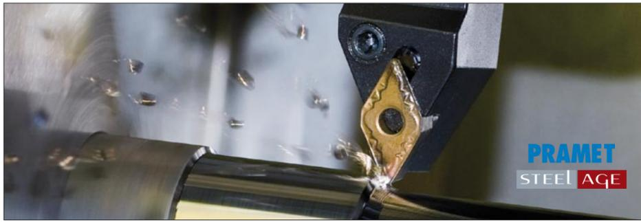
**FM стружколомающая геометрия для чистового и получистового точения**
