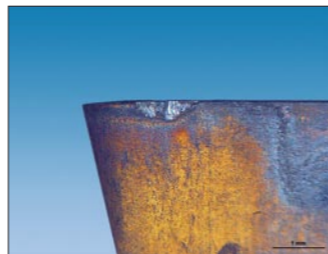
Прамет 8230 - режущая кромка (44 мин.)
