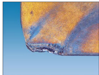
Конкурент - передняя поверхность (44 мин.)
