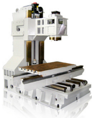
Станина обрабатывающего центра, защита направляющих и зоны резания снята
