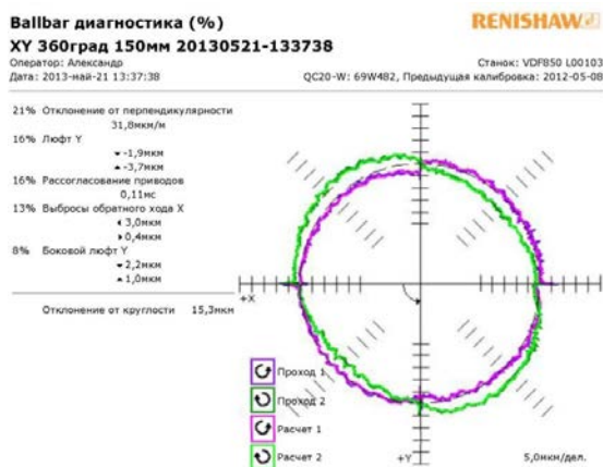
проверка станка на точность при предпродажной подготовке
