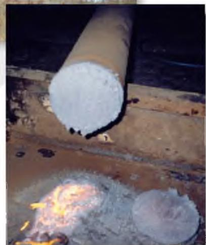
Образец реза блока цилиндров
