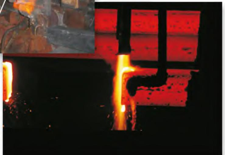
**«ДОНМЕТ» 511 - мощный резак для машинной резки с внешним смешением газов**
