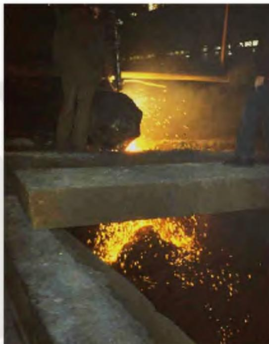
**Резка козла толщиной до 450 мм**
