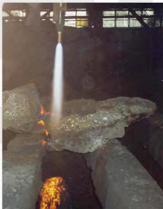
**«ДОНМЕТ» 523 - водоохлаждаемый резак для машинной резки**
