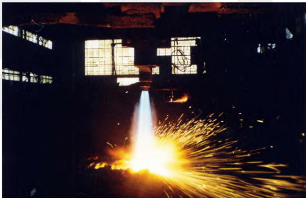
**«ДОНМЕТ» 516 - сверхмощный резак для машинной резки**
